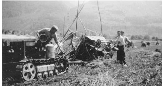
Ein Raupentraktor zieht den Bindemäher, der das Getreide bündelt und die Garben maschinell geschnürt herausgibt.
