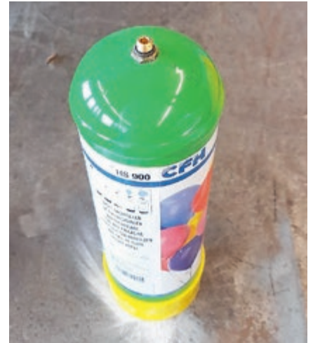
Helium-Gasflasche mit Ventil gilt so als befüllt und darf nicht im Altmetall entsorgt werden.
