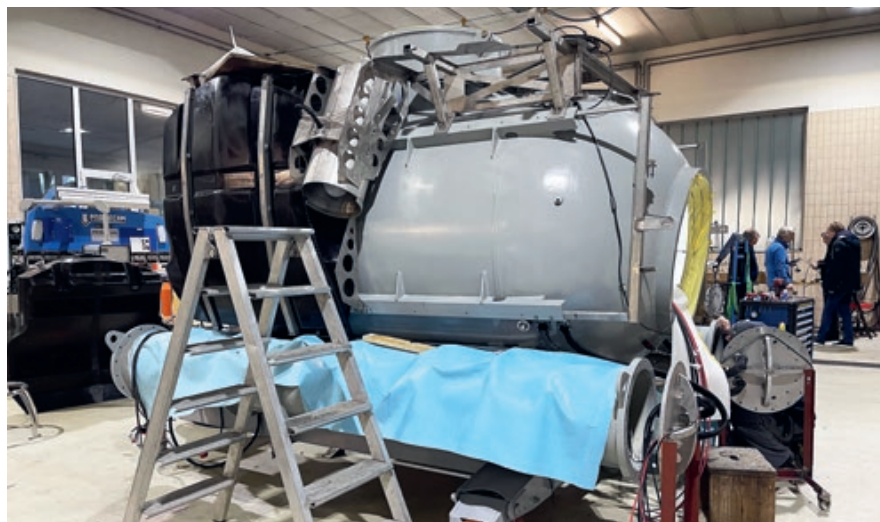
U-Boot Druckkörper, grauer Teil, dunkle Tauchtanks in der AT-Werkhalle
